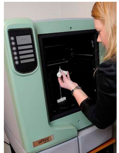
3D-skrivaren bygger upp modellen lager för lager i ABS-plast. Den kan till och med skriva ut sammansatta modeller i en enda utskrift – cykeln på bilden kan både rulla och styras!
